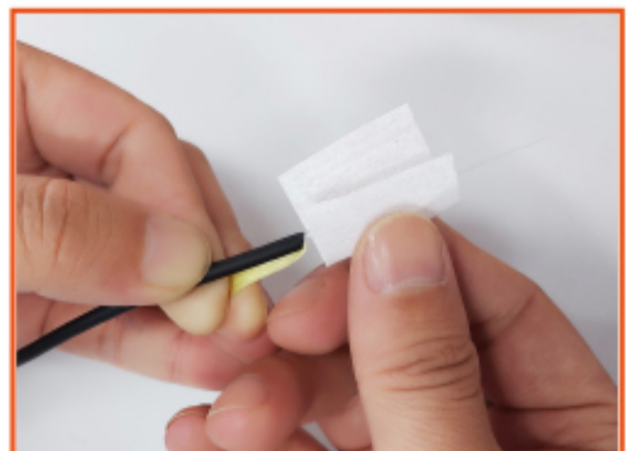
6. Limpiar la fibra con toalla libre de pelusa y alcohol isopropílico
