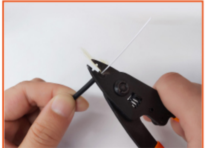
4. Desforrar buffer de 900 micras
