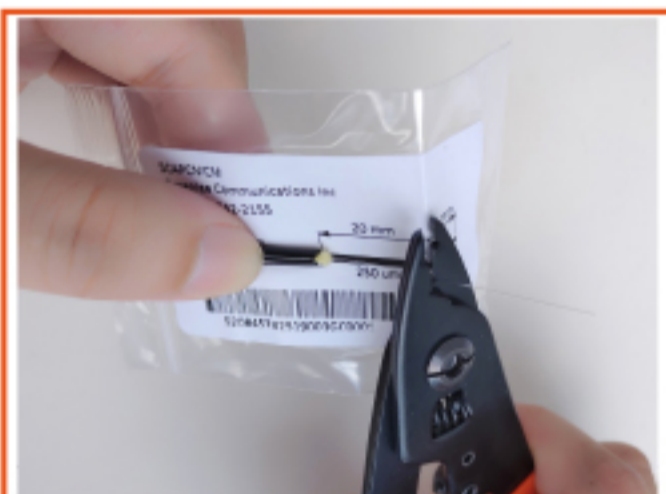
5. Utilizando la métrica desforrar el acrilato de 250 micras
